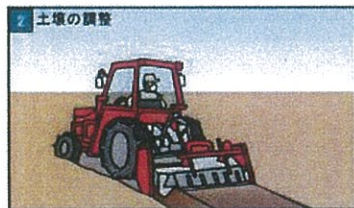
2 土壤の調整 墾土はていねいに行ってください。土の固まりが多いと有効なガスが抜けて効果不十分の原因となります。植物の残りがす等は取り除いてください。
